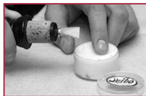
Lubrifier les bouchons (Seibo)
